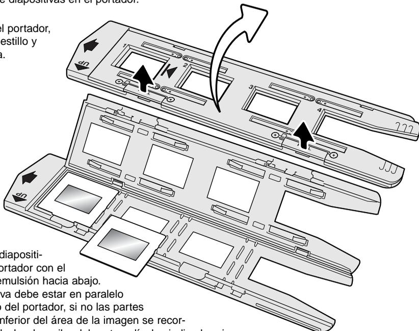
Inserte las diapositivas en el portador con el lado de la emulsión hacia abajo. La diapositiva debe estar en paralelo con el largo del portador, si no las partes superior e inferior del área de la imagen se recortarán. La flecha de arriba del porta películas indica la orientación de las imágenes horizontales.
