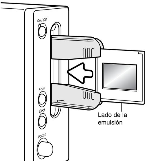
Cuando el porta monturas de diapositivas está en el escáner, la última diapositiva se puede quitar e insertar una nueva sin necesidad de extraer el portador. Cuando reemplace diapositivas, tenga cuidado de no cambiar la posición del portador. Se debe realizar un pre-escaneado cada vez que se inserte una diapositiva; consulte el manual del Escáner DiIMAGE.
