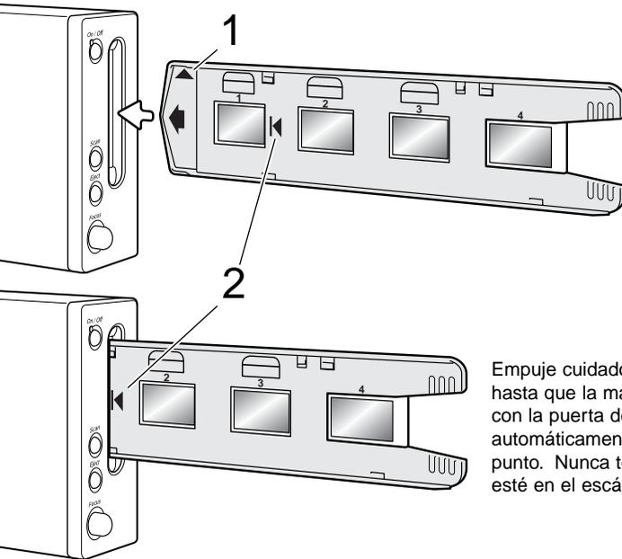
Cuando la luz indicadora brille de forma fija, inserte el porta películas en el escáner en la dirección indicada por la flecha. Sujete el portador derecho y recto con el indicador de orientación hacia arriba (1).
