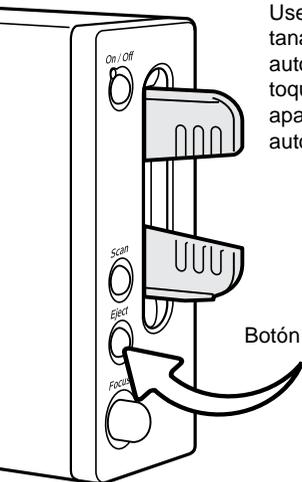
Use el botón de extraer situado en el cuerpo del escáner, o mediante la ventana de la Utilidad del Escáner DiMAGE, para retirar el portador; el escáner automáticamente extrae el portador a su posición inicial de inserción. No toque ni estorbe al portador mientras se esté moviendo. Si el escáner se apaga antes de salir el portador, encienda el escáner; el portador saldrá automáticamente.
