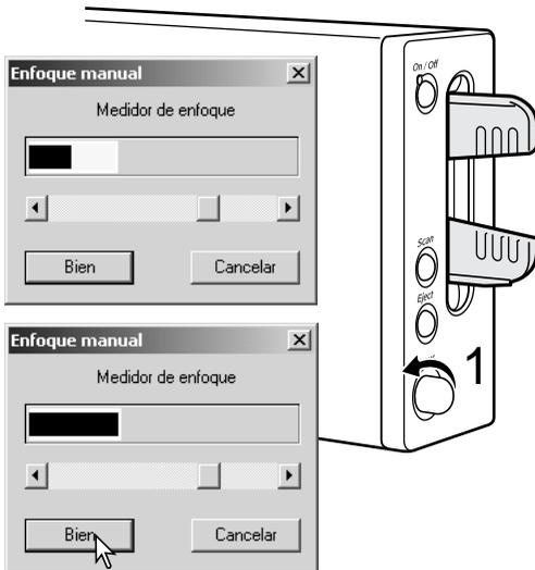
Gire el sintonizador de enfoque (1) hasta que las barras blanca y negra estén en su máxima extensión. La barra negra indica el cambio en el enfoque. La barra blanca indica la mayor extensión de la barra negra y el punto de enfoque más nítido. No toque ni interfiera con el portador.
