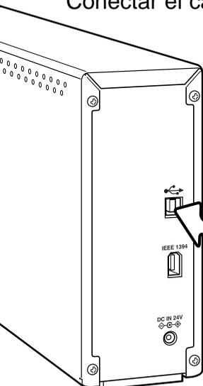
Inserte bien el conector "A" del cable USB dentro del puerto USB del escáner, y el conector "B" dentro del puerto USB del ordenador.
