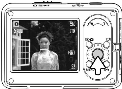
Halten Sie die mittlere Steuertaste gedrückt, um das Spot-AF-Messfeld anzuzeigen; durch erneutes Drücken und Halten wechseln Sie zwischen dem großen AF-Messfeld und dem Spot-AF-Messfeld. Nehmen Sie das Bild, wie im Abschnitt „Aufnahmemodus – Grundlagen“ auf Seite 25 beschrieben, auf.
