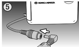
5. Stecken Sie den kleinen Stecker des Netzgerätes in die Netzgerätanschlussbuchse des Gleichstrom-Adapters.
