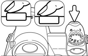
Platzieren Sie Ihr Motiv im Bild, wie auf S. 22 beschrieben. Drücken Sie den Auslöser leicht an, um die Scharfeinstellung und Belichtungseinstellung zu speichern. Drücken Sie zum Start der Filmaufnahme den Auslöser einmal ganz durch.
