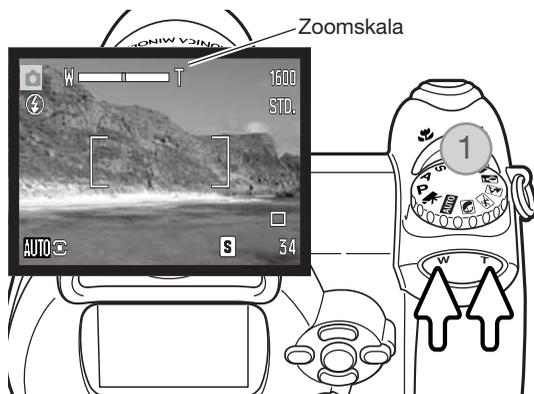
Mit dem Zoomhebel stellen Sie die Zoomposition ein (1). Durch Drücken des Zoomhebels nach rechts (T) vergrößert sich die Brennweite (Tele). Durch Drücken nach links (W) verringert sich die Brennweite (Weitwinkel).
