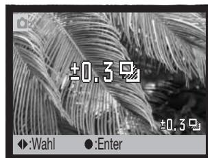
Wenn Sie den benutzerdefinierten Weißabgleich auswählen, wird der Bildschirm zum Einstellen des Weißabgleichs angezeigt. Wählen Sie eine formatfüllende weiße Fläche aus und drücken Sie die mittlere Steuertaste, um den Weißabgleich durchzuführen und die Kamera zu kalibrieren.
