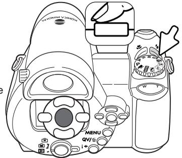
Bei Auswahl der Bildfolge „Reihenaufnahme“ oder des voreingestellten Weißabgleichs erscheint ein Auswahlbildschirm. Verwenden Sie die linke/rechte Steuertaste, um die Abstufung bei der Reihenaufnahme bzw. den voreingestellten Weißabgleich anzuzeigen und drücken Sie Bestätigung die mittlere Steuertaste.
