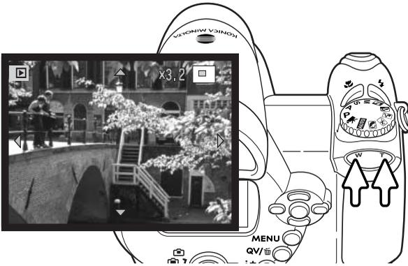
Drücken Sie, wenn das zu vergrößerte Bild angezeigt wird, den Zoomhebel nach rechts (T), um die vergrößerte Bildanzeige zu aktivieren. Der Grad der Vergrößerung wird auf dem LCD-Monitor angezeigt.
