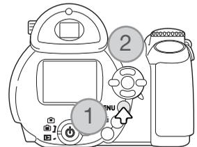
Wurde eine Einstellung übernommen, gelangen Sie zurück zu den Menüpunkten und die neue Einstellung wird angezeigt. Um in den Aufnahmemodus zurück zu gelangen, drücken Sie die Menütaste.
