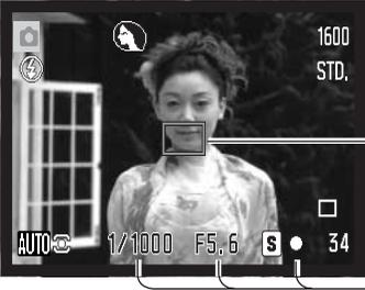
Platzieren Sie das Motiv innerhalb des AF-Rahmens. Drücken Sie den Auslöser leicht an und halten Sie ihn gedrückt.
