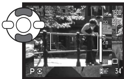
Drücken Sie bei manueller Scharfeinstellung unter Verwendung der Zeitautomatik, Blendautomatik oder des manuellen Belichtungsmodus (S. 36–38) die mittlere Steuertaste, um zwischen der Scharfstellung mit der oberen/unteren Steuertaste und der Einstellung der Belichtung zu wechseln. Die aktive Funktion ist blau gefärbt.
