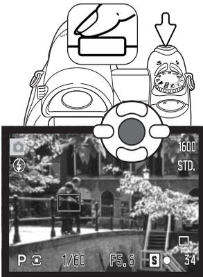
Führen Sie die Bildkomposition wie in den Grundlagen der Aufnahme beschrieben durch; drücken Sie den Auslöser leicht an (1), um die Belichtungswerte und die Scharfeinstellung einzustellen und zu fixieren. Drücken Sie den Auslöser ganz durch, um das Bild aufzunehmen.
