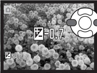
Drücken Sie zur Einstellung der Belichtung zunächst die rechte Steuertaste; der Bildschirm „Belichtungskorrektur“ erscheint.
