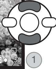
Stellen Sie mit der oberen/unteren Steuertaste (1) die gewünschte Verschlusszeit ein. Drücken Sie den Auslöser leicht an, um das Belichtungsmesssystem zu aktivieren; der jeweilige Blendenwert wird auf dem Monitor angezeigt.
