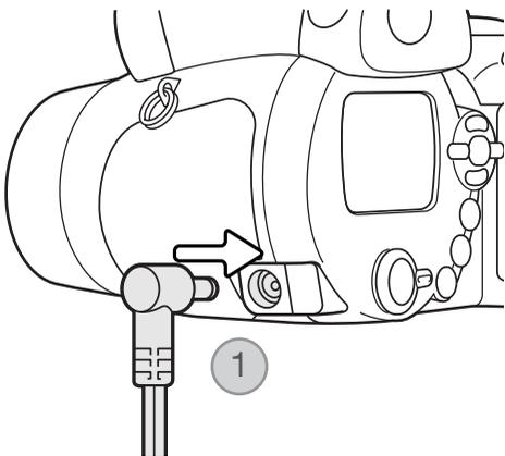
Die Kamera kann über ein Netzgerät extern mit Strom versorgt werden, was bei längerem Gebrauch der Kamera oder wenn die Kamera mit einem Computer verbunden ist, empfohlen wird. Das Netzgerät gibt es in zwei Ausführungen: Modell AC-1L für Nordamerika und Japan und Modell AC-11 für alle anderen Länder.
