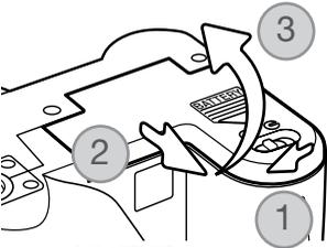
Um das Batteriefach zu öffnen, schieben Sie den Verschluss des Batteriefachdeckels auf die Position „Öffnen“ (1). Schieben Sie den Deckel in Richtung Vorderseite der Kamera, um die Verriegelung zu lösen (2). Klappen Sie den Deckel dann nach oben (3).
