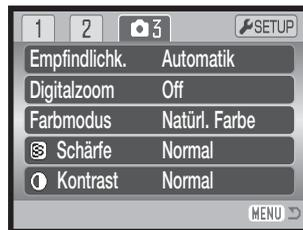
Die Einstellung „Automatik“ passt die Empfindlichkeit dem Umgebungslicht zwischen ISO 64 und 100 an. Bei allen anderen Einstellungen werden „ISO“ und die eingestellte ISO-Zahl auf dem Monitor angezeigt.
