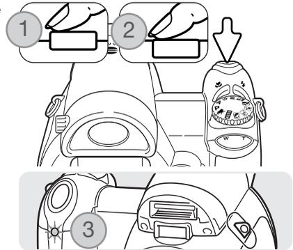
Drücken Sie den Auslöser nicht, wenn Sie vor der Kamera stehen, weil dann die Scharfeinstellung und die Belichtungswerte falsch eingestellt werden. Die Scharfeinstellung sollte zuerst durch das Schärfesignal bestätigt sein, bevor der Selbstauslöser gestartet wird (S. 25).
