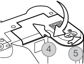
Schließen Sie den Batteriefachdeckel und schieben Sie ihn in Richtung Rückseite der Kamera (4), bis die Verriegelung einrastet. Schieben Sie den Verschluss des Batteriefachdeckels auf die Position „Schließen“ (5).
