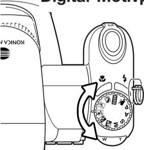
Die Digital-Motivprogramme optimieren die Belichtung, den Weißabgleich und die Bildverarbeitungsprozesse, um so beste Ergebnisse für die gewählte Motivsituation zu erzielen. Drehen Sie einfach das Belichtungsmodusrad auf die entsprechende Position für das gewünschte Digital-Motivprogramm; das aktivierte Digital-Motivprogramm wird in der unteren linken Ecke des Monitors angezeigt.
