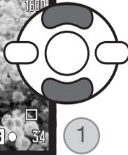
Verwenden Sie die obere/untere Steuertaste (1), um die Blende festzulegen. Die Blende hat drei Einstellmöglichkeiten. Drücken Sie den Auslöser leicht an, um das Belichtungsmesssystem zu aktivieren; die jeweilige Verschlusszeiten-Anzeige wird auf dem Monitor angezeigt.
