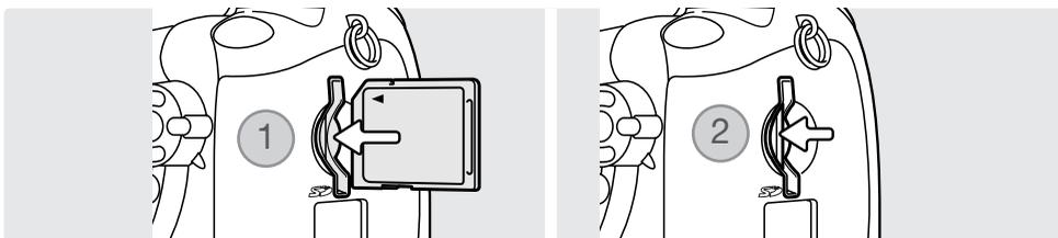
1. Schieben Sie die Speicherkarte soweit in den Kartenschacht bis sie einrastet. Legen Sie sie mit der Vorderseite in Richtung der Rückseite der Kamera ein. Achten Sie darauf, die Karte nicht zu verkanten und wenden Sie niemals übermäßige Kraft an. Sollte die Karte blockieren, überprüfen Sie deren korrekte Ausrichtung.
