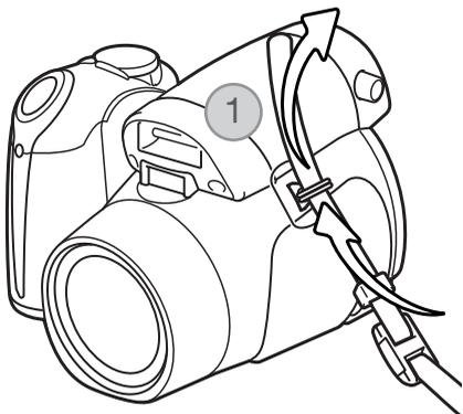
Ziehen Sie das Ende des Trageriemens durch die Öse an der Kamera (1).
