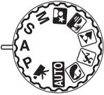
Der Fotograf wählt die gewünschte Blende vor, und die Zeitautomatik stellt die passende Verschlusszeit für die korrekte Belichtung ein. Wenn die Zeitautomatik aktiv ist, leuchtet die Blendenzahl in der Anzeige blau und ein Doppelpfeil wird daneben angezeigt. Sie können zum Blitzen die Blitzfunktionen „Aufhellblitz“, „Aufhellblitz mit Verringerung des „Rote-Augen-Effekts“ sowie „Langzeitsynchronisation mit Verringerung des „Rote-Augen-Effekts“ verwenden (S. 26).
