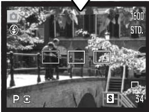
Benutzen Sie die linke/rechte Steuertaste, um das gewünschte Spot-AF-Messfeld zu markieren; der aktive Bereich ist blau gefärbt.
