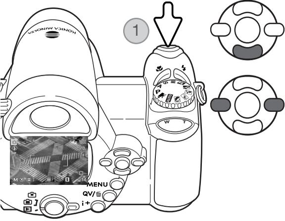
Erhöhen Sie mit der unteren Steuertaste die Verschlusszeit über 15 Sekunden, bis „T“ angezeigt wird.
