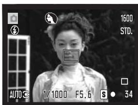
Drücken Sie den Auslöser leicht an. Das AF-System wird das Motiv finden und die digitale Motivprogrammwahl wählt ein Programm. Wird kein Symbol eingeblendet, ist die Belichtungsautomatik aktiv. Drücken Sie den Auslöser ganz durch, um das Bild aufzunehmen. Halten Sie die Kamera ruhig, wenn das Programm „Sonnenuntergang“ ausgewählt ist, denn die Verschlusszeit kann hierbei lang sein.
