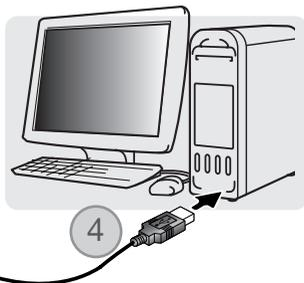
4. Stecken Sie das andere Ende des USB-Kabels in den USB-Anschluss des Computers. Vergewissern Sie sich, dass der Stecker fest sitzt. Die Kamera sollte direkt an den USB-Anschluss des Computers angeschlossen werden. Das Anschließen der Kamera an einen USB-Hub kann die korrekte Funktion der Kamera beeinträchtigen.
