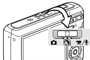
La sélection automatique de programmes-résultats numériques choisit automatiquement entre le mode programme général et 5 programmes-résultats. Les programmes-résultats optimisent les réglages de l'appareil en fonction des sujets. La sélection automatique de programme-résultat numérique est disponible uniquement en mode Enregistrement auto et peut être désactivée dans le menu du mode Enregistrement auto. Pour plus d'informations sur les programmes-résultats, voir page 30.
