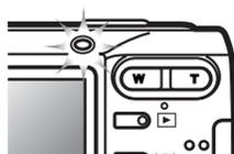
Si l'alimentation est insuffisante pour permettre à l'appareil de fonctionner, la lampe témoin située au-dessus de l'écran ACL s'allume en orange et clignote quelques secondes, lorsque l'appareil est mis sous tension ; ou bien, l'avertissement de batterie déchargée apparaît sur l'écran ACL juste avant que l'appareil ne s'éteigne complètement. Le déclencheur ne pourra plus être activé. La batterie doit être rechargée.
