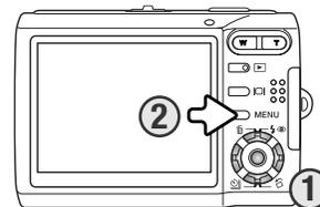
La navigation dans ce menu est simple. Les touches gauche/droit et haut/bas du contrôleur (1) pilotent le curseur et modifient les réglages du menu. Une pression sur la touche centrale du contrôleur sélectionne les options et valide les ajustements.
