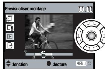
Une fois la lecture effectuée, utiliser la touche bas pour passer à l'étape suivante si le montage est satisfaisant. Pour modifier le montage, utiliser la touche haut du contrôleur pour revenir à l'étape précédente et sélectionner la première et la dernière vue de la partie à supprimer. Appuyer sur la touche menu pour annuler le montage.
