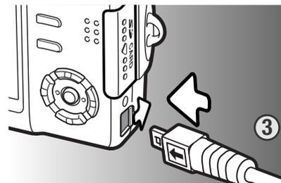
3. Faire glisser le couvercle de la prise USB. Raccorder le petit connecteur du câble USB à l'appareil. Insérer le connecteur bien droit. S'assurer que le connecteur est bien fixé.
