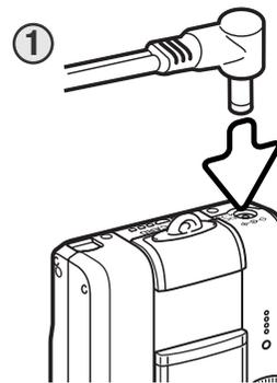
L'adaptateur secteur AC-4 ou AC-5 permet à l'appareil photo d'être alimenté depuis une prise murale. L'adaptateur secteur est recommandé lorsque l'appareil photo est en interface avec un ordinateur ou pendant des périodes d'utilisation intense. Le modèle d'adaptateur secteur AC-4 est prévu pour l'Amérique du Nord, le Japon et Taïwan, le modèle AC-5 pour les autres régions. La batterie ne peut être chargée avec cet adaptateur.
