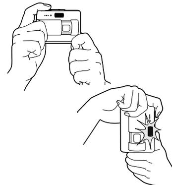
Pour prendre des photos verticales, tenir l'appareil de manière à ce que le flash soit au-dessus de l'objectif, le déclencheur vers le haut. Prendre soin de ne pas masquer l'objectif avec les doigts ou la dragonne.
