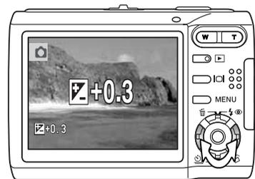
En mode Enregistrement, utiliser les touches gauche/droite du contrôleur pour modifier la fonction sélectionnée avec le menu.
