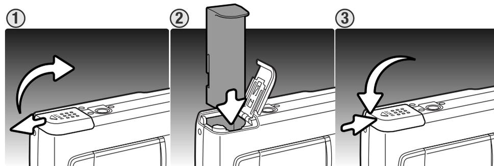
1. Faire glisser le couvercle du logement de la batterie sur le côté de l'appareil pour déverrouiller l'attache de sûreté. Ouvrir le couvercle.
