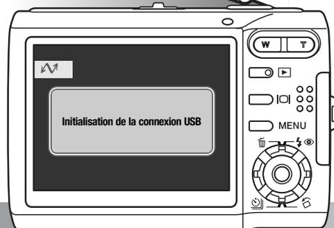
5. Mettre l'appareil sous tension pour initialiser la connexion USB. Lorsque l'appareil est connecté à un micro-ordinateur, l'écran de transfert de données s'affiche.
