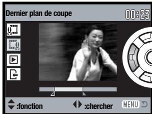
Utiliser les touches gauche/droite du contrôleur pour afficher la dernière vue de la partie à supprimer. L'échelle située sous l'image et le minuteur situé dans le coin supérieur droit indiquent la situation approximative du point.
