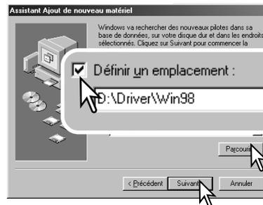
Indiquer le répertoire d'installation du pilote. La fenêtre "Parcourir" peut être utilisée pour indiquer le répertoire. Le pilote est situé sur le CD-Rom dans le répertoire correspondant au chemin d'accès : \Win98\USB. Lorsque le répertoire apparaît dans la fenêtre, cliquer sur "Suivant".
