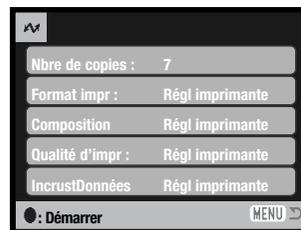
Le nombre d'impressions est affiché ainsi que les paramètres d'impression sélectionnés avec le menu. Voir la section sur la navigation du menu pour davantage d'informations (p. 96). Appuyer au centre du contrôleur pour lancer l'impression, ou appuyer sur la touche Menu pour revenir à l'écran PictBridge.
