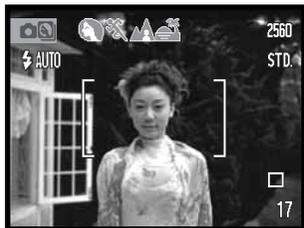
Cadrer le sujet dans la zone de mise au point et s'assurer que ce sujet est bien dans la plage de distances couvertes par l'objectif (p. 26). Pour des sujets très proches, utiliser la fonction Super Macro (p.30).
