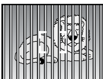
Dos objetos en distancias diferentes se solapan en el marco de enfoque
