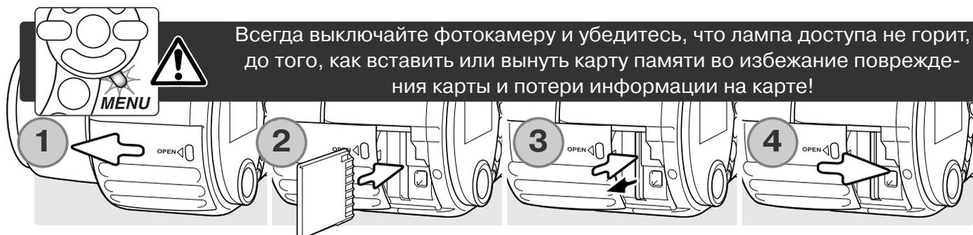
1. Откройте крышку отсека с картой (1), сдвинув ее в сторону передней панели камеры.
