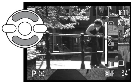
При съемке в режимах приоритета выдержки, приоритета диафрагмы или в режиме ручной установки параметров экспозиции (с. 36-38) при ручной фокусировке нажмите центральную кнопку контроллера для переключения функции фокусировки или коррекции экспозиции для кнопок “вверх/вниз” контроллера. Активная в данный момент функции выделяется синим цветом.
