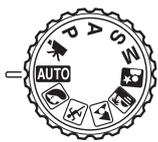
Меню режима съемки отображает нужные настройки в соответствии с позицией переключателя режимов экспозиции фотокамеры. Существует четыре вида меню, отображающихся, в зависимости от того, какой режим съемки выбран: автоматический, режим записи видео, Цифровая Сюжетная Программа или экспозиционные режимы P, A, S или M.
