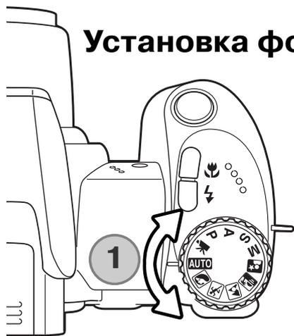
Поверните Переключатель режимов экспозиции в положение автоматического режима съемки (1). Все параметры работы фотокамеры теперь полностью автоматизированы. Автофокус, экспозиция, системы обработки изображений будут работать совместно для получения прекрасных результатов безо всяких усилий.
