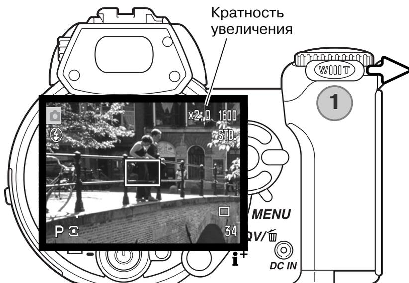
Управление цифровым зумом осуществляется при помощи рычажка (1). Подвиньте рычажок вправо (T), чтобы перевести объектив в телеположение. Если включена функция цифрового зума, в верхней части экрана будет отображена степень увеличения. Подвиньте рычажок зума влево (W), чтобы уменьшить эффект зума.
