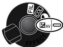
L'esposizione con luce ambiente e con flash può essere regolata prima di riprendere l'immagine per far sì che la fotografia risulti più chiara o più scura. L'esposizione può essere regolata di  $\pm 2\text{Ev}$  con incrementi di  $1/3\text{Ev}$  (p. 79). Il valore di compensazione dell'esposizione e del flash impostato resta attivo finché non viene reimpostato.
