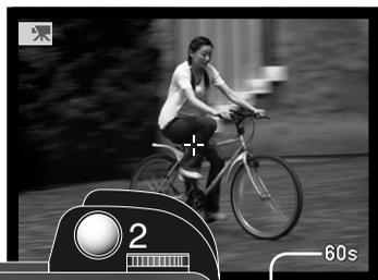
Impostate il selettore principale sulla registrazione immagini in movimento (1). Prima della registrazione, il contapose sullo schermo LCD e sul pannello indicatore segnala i secondi disponibili per la registrazione. L'indicazione 60 resta visualizzata finché il tempo residuo non scende sotto il minuto.
