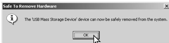
Se ci sono più apparecchi esterni collegati al computer, ripetete la procedura descritta usando però il tasto destro del mouse per fare un click sull'icona di disconnessione o espulsione dell'hardware e selezionare il dispositivo da disconnettere.
