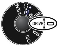
L'impostazione del tipo di scatto controlla il rapporto e il metodo di ripresa delle immagini. I simboli relativi al tipo di scatto scelto sono visualizzabili sul pannello indicatore, sul mirino elettronico (EVF) e sullo schermo LCD. Fate riferimento al paragrafo relativo al selettore di funzione alla p. 48.
