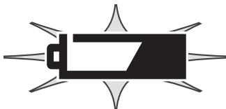
Simbolo batteria in esaurimento (pulsante) - Questo indicatore compare da solo sul pannello. La carica delle batterie non è sufficiente ad alimentare le operazioni della fotocamera. L'otturatore non scatta. Sostituite o ricaricate subito le batterie.
