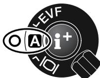
Visualizzazione automatica - La fotocamera cambia automaticamente la visualizzazione dell'immagine inquadrata da mirino elettronico a schermo LCD e viceversa. I sensori nell'oculare del mirino elettronico rilevano quando è in uso il mirino e modificano di conseguenza la visualizzazione.
