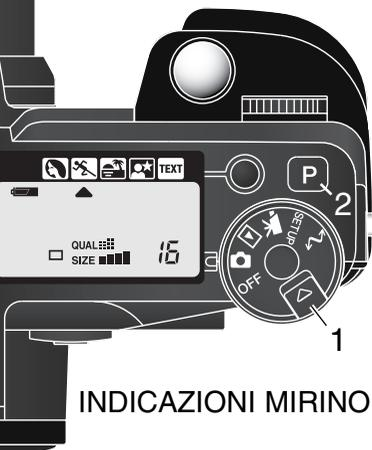
Tenendo premuto lo sblocco del selettore (1), ruotate il selettore di impostazione sulla registrazione di immagini statiche: si attivano il mirino EVF e lo schermo LCD. Premete quindi il pulsante Pro-auto (2) per reimpostare le funzioni programmate e automatiche.
