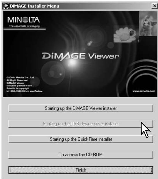
Prima di collegare la fotocamera al computer, inserite il CD-ROM DiMAGE nel drive per CD-ROM. Il menu dell'installatore DiMAGE si apre automaticamente. Fate un click sul pulsante di avvio dell'installatore dell'apparecchio USB per installare automaticamente il driver USB con Windows 98. Si apre la finestra di richiesta di conferma dell'installazione del driver. Fate un click su "Yes" per continuare.
