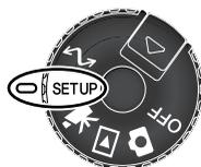
Ruotate il selettore di impostazione sulla calotta della fotocamera verso la posizione setup. La fotocamera si accende e compare il menu di setup.
