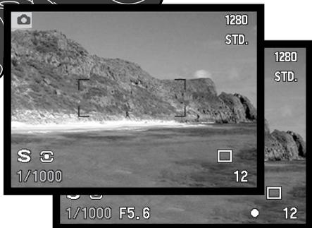
I tempi di scatto possono essere modificati con incrementi di mezzo valore da 15 sec. a 1/2000 di sec. quando la sensibilità della fotocamera è impostata su Auto (p. 71). Se il tempo di scatto non rientra nelle possibilità delle aperture di diaframma, l'indicazione del diaframma pulsa sul pannello indicatore e si colora di rosso sul mirino EVF e sullo schermo LCD.
