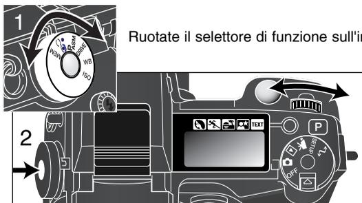
Ruotate il selettore di funzione sull'impostazione da modificare (1).
