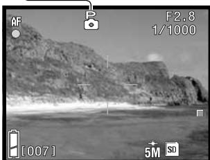
Le operazioni dell'esposizione programmata sono uguali a quelle descritte nel paragrafo delle operazioni base di registrazione (p. 24); premendo parzialmente il pulsante di scatto l'apertura di diaframma e il tempo di scatto usati nell'esposizione compaiono nell'angolo in alto a destra dello schermo LCD.
