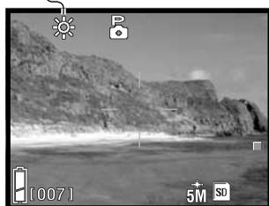
Quando viene selezionata una funzione pre-impostata di bilanciamento del bianco, un indicatore viene visualizzato sullo schermo LCD per segnalare l'attivazione. Gli effetti sono visibili sull'immagine inquadrata. Se volete mantenere la luce ambiente, impostate l'esclusione del flash (p. 28). Se il flash incorporato scatta con un bilanciamento del bianco pre-impostato, il bilanciamento viene impostato sulla temperatura colore del flash.
