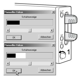
Drehen Sie das Schärferad (1), bis der schwarze-weiße Balken die weiteste Ausdehnung aufweisen. Der schwarze Balken weist auf die Änderung der Scharfeinstellung hin. Der weiße Balken zeigt die längstmögliche Ausdehnung des schwarzen Balkens bzw. den Punkt mit der größten Schärfe an. Berühren Sie während dieses Vorgangs nicht den Filmhalter.
