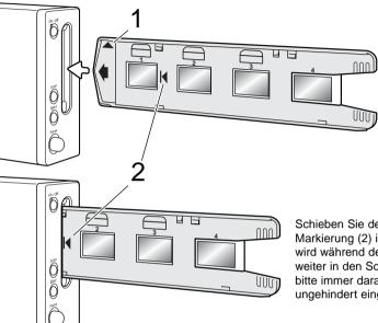
Sobald die Bereitschaftsanzeige dauerhaft leuchtet, schieben Sie den Filmhalter in Pfeilrichtung in den Scanner. Achten Sie dabei darauf, dass der Filmhalter gerade undmit dem Orientierungspfeil (1) nach oben eingelegt wird.
