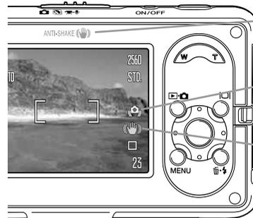
Indicador de Anti-Vibración encendida
