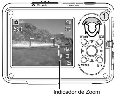
Para utilizar el zoom acercando el objeto, empuje el lado derecho (T) de la palanca del zoom (1).
