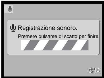
Per avviare la registrazione, premete e rilasciate il pulsante di scatto (3). Il contapose mostra il tempo disponibile. L'operazione si interrompe automaticamente al termine della durata impostata o ripremendo il pulsante di scatto.
