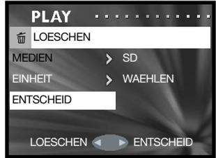
Wenn bei der Einheit-Funktion „WAEHLEN“ ausgewählt wurde, erscheint die Anzeige für Einzelbildauswahl. Wählen Sie ein Bild oder mehrere Bilder, die Sie löschen möchten, aus, indem Sie den roten Rahmen um das gewünschte Index-Miniaturbild legen und die Menütaste drücken. Ein gelber Rahmen zeigt die Auswahl an. Wählen Sie nun „END“, und drücken Sie die Menütaste um fortzufahren. Informationen hierzu finden Sie auf S. 57.
