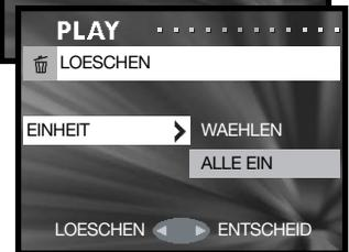
Die Medien-Funktion zeigt die Speicherkarte an, auf der Dateien gelöscht werden sollen. SD steht für eine SecureDigital-Speicherkarte oder Multi-Media-Speicherkarte, und MS steht für ein Memory-Stick. Mit der Funktion „EINHEIT“ können entweder einige (WAEHLEN) oder alle Dateien (ALLE EIN) gelöscht werden.
