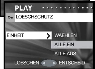
Die Medien-Funktion zeigt die Speicherkarte an, die schreibgeschützt ist. SD steht für eine SecureDigital-Speicherkarte oder Multi-Media-Speicherkarte, und MS steht für ein Memory-Stick. Mit der Funktion „EINHEIT“ können entweder einige (WAEHLEN) oder alle Dateien (ALLE EIN) geschützt werden. Mit der „ALLE AUS“-Funktion wird der Schreibschutz aller Dateien aufgehoben.
