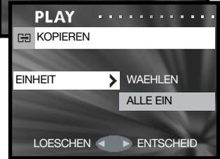
Die Kopieren-Funktion zeigt die Quell- und Ziel-Speicherkarten an. SD steht für eine SecureDigital-Speicherkarte oder Multi-Media-Speicherkarte, und MS steht für Memory-Stick. Mit der Funktion „EINHEIT“ können entweder einige (WAEHLEN) oder alle Dateien (ALLE EIN) kopiert werden.
