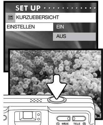
Die Schnellansicht kann vor Ablauf der Wiedergabezeit abgebrochen werden, indem der Auslöser leicht angedrückt wird. Bei der Reihenaufnahme-Funktion (S. 24) wird die Schnellansicht nach jeder erstellten Aufnahme aktiviert. Wenn der Monitor ausgeschaltet ist, wird dieser für die Wiedergabezeit der Schnellansicht automatisch eingeschaltet.
