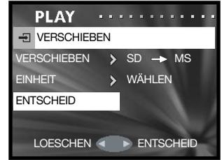
Wenn bei der Einheit-Funktion „WAEHLEN“ ausgewählt wurde, erscheint die Anzeige für Einzelbildauswahl. Wählen Sie ein Bild oder mehrere Bilder, die verschoben werden sollen, aus, indem Sie den roten Rahmen um das gewünschte Index-Miniaturbild legen und die Menütaste drücken. Ein gelber Rahmen zeigt die Auswahl an. Wählen Sie nun „END“, und drücken Sie die Menütaste um fortzufahren. Informationen hierzu finden Sie auf S. 57.
