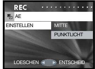
**Mittenbetonte Integralmessung:** Bei der mittenbetonten Integralmessung bestimmt die Kamera die Belichtung auf Grund des sich in der Mitte des Rahmen befindlichen Objekts. Diese Art der Messung liefert in nahezu allen Situationen eine genaue Belichtung.
