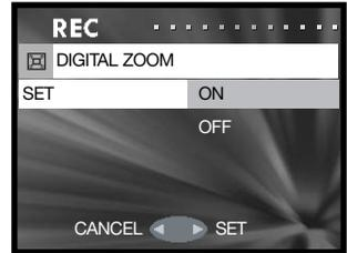
Bei maximalem optischem Zoom in Telestellung müssen Sie die rechte Zoomtaste drücken, um das 2fach oder 3fach Digitalzoom einzuschalten. Die Vergrößerung durch das Zoom wird über dem Bildzähler angezeigt. Zum Verkleinern müssen Sie die linke Zoomtaste drücken.
