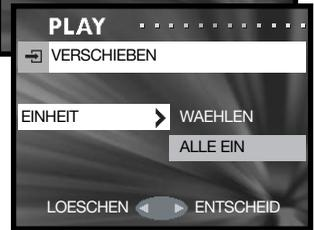
Die Verschieben-Funktion zeigt die Quell- und Ziel-Speicherkarte an. SD steht für eine SecureDigital-Speicherkarte oder Multi-Media-Speicherkarte, und MS steht für ein Memory Stick. Mit der Funktion „EINHEIT“ können entweder einige (WAEHLEN) oder alle Dateien (ALLE EIN) verschoben werden.
