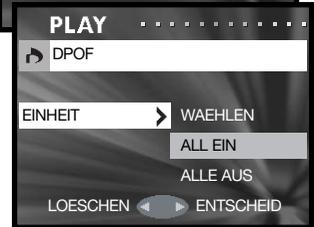
Die Medienfunktion zeigt die Speicherkarte an, von der Dateien gedruckt werden sollen. SD steht für eine SecureDigital-Speicherkarte oder Multi-Media-Speicherkarte, und MS steht für Memory-Stick. Mit der Funktion „EINHEIT“ können entweder einige (WAEHLEN) oder alle Dateien (ALLE EIN) gedruckt werden, oder die DPOF-Datei wird gelöscht (ALLE AUS). Mit der Datum-Funktion werden entweder Datum und Uhrzeit der Aufnahme bei jedem Bild (ALLE EIN) mit ausgedruckt oder nicht (ALLE AUS).
