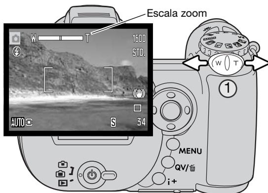
A alavanca de zoom controla a objectiva (1). Deslizando a alavanca para a direita coloca a objectiva na posição telefoto (T). Deslizando-a para a esquerda coloca na posição de grande angular (W).
