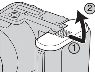
Para abrir a porta do compartimento das pilhas, deslize a porta para a zona lateral da câmara (1) para libertar o fecho de segurança. Levante a porta para a abrir (2).
