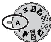
O utilizador selecciona a abertura e a câmara fixa a velocidade apropriada para assegurar uma exposição correcta. Quando se selecciona o modo de prioridade para a abertura o valor da abertura no monitor fica azul e um indicador de seta dupla aparece perto do valor. O modo de flash pode ser ajustado para flash de enchimento, flash de enchimento com redução de olhos vermelhos, ou sincronização lenta (p. 26).
