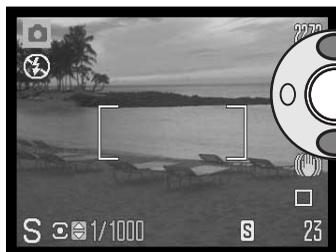
Use as teclas para cima/baixo do controlador (1) para ajustar o valor de velocidade. Prima o disparador até meio para activar o sistema de exposição; o valor de abertura correspondente será exibido no monitor.
