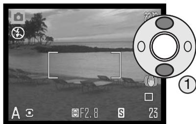
Use as teclas para cima/baixo do controlador (1) para ajustar o valor de abertura desejado. O valor de abertura pode ser ajustado em incrementos de 1/3 de intervalo. Prima o disparador para activar o sistema de exposição; o valor de velocidade correspondente será exibido no monitor.
