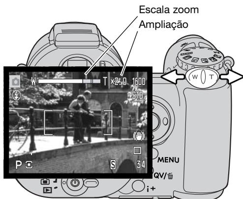
O zoom digital é operado pela alavanca de zoom (1). Deslizando a alavanca para a direita (T) posicionará a objectiva em telefoto. Quando o zoom digital é activado, a ampliação da imagem será exibida no monitor. Rode a alavanca para a esquerda para grande angular (W). Após o zoom, a escala de zoom é exibida por breves momentos. A secção amarela indica o alcance do zoom digital.
