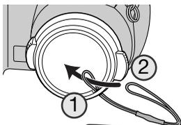
Passes um dos laços mais pequenos da correia da tampa da objectiva através da abertura existente na tampa da objectiva (1). Passe o outro laço através do primeiro e aperte (2).
