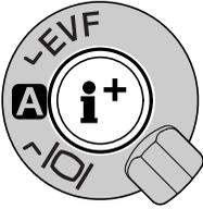
In der Mitte des Anzeige-Schalters, sitzt die Anzeige-Informationstaste. Mit dieser Taste können Sie festlegen, welche Informationen mit der Bildvorschau angezeigt werden. Die Anzeige wechselt bei jedem Drücken der Taste zwischen:
