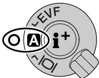
Automatische Anzeige – Die Augensensoren des EVF beobachten, ob der EVF benutzt wird, und schalten die Anzeige dementsprechend auf den richtigen Monitor.
