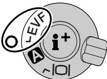
EVF-Anzeige – Das Bild wird ausschliesslich im Elektronischen Sucher angezeigt. Bei hellem Umgebungslicht erkennt man das EVF-Bild besser als das LCD-Monitorbild.
