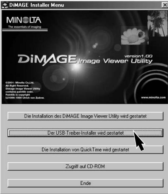
Legen Sie die DiMAGE Software CD-ROM in den Computer ein, bevor Sie die Kamera mit dem Computer verbinden. Das Installationsmenü sollte automatisch erscheinen, falls für das CD-ROM-Laufwerk die „Auto-Start“ im Gerätemanager aktiviert ist. Um den Windows 98 USB-Treiber automatisch zu installieren, klicken Sie auf „Installation des Windows 98 USB Treibers“. Es erscheint ein Bestätigungsdialog. Klicken Sie auf „JA“, um mit der Installation fortzufahren.
