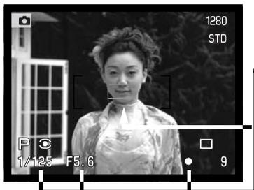
Stellen Sie sicher, dass sich das Motiv innerhalb des Autofokus-Rahmens befindet. Drücken Sie den Auslöser leicht an oder drücken und halten Sie die AF/AEL-Speichertaste.
