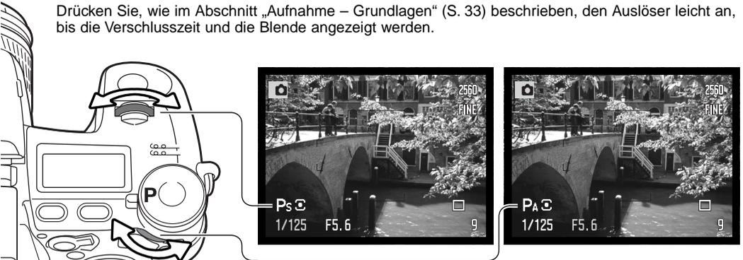
Drehen Sie entweder das vordere oder das hintere Einstellrad, um die Zeit/Blendenkombination zu verschieben (Shiften); jede Kombination ergibt eine gleich belichtete Aufnahme. Die Werte werden in Stufen von 0,3 EV bzw. in 1/3 Blendenstufen verschoben. Das vordere Einstellrad verändert die Verschlusszeit (Ps), während das hintere Einstellrad die Blendenzahl verändert (Pa); der zugehörige Anzeigewert erscheint jeweils blau.
