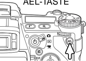
Wenn Sie die AEL-Taste drücken und gedrückt halten, wird die Belichtung festgesetzt. Die Belichtungsmessung bleibt nach der Aufnahme solange gespeichert, bis die AE-Taste losgelassen wird (AE Tast.) oder abermals gedrückt wird (AE Schalt.). Die Einstellungen für die AE-Taste können im Register 1 des Aufnahmemenüs (S. 80) gewählt werden
