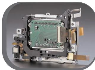
Die Anti-Shake-Einheit kompensiert Bildverwacklungen bei Kameraerschütterungen durch Verschieben des CCDs.
