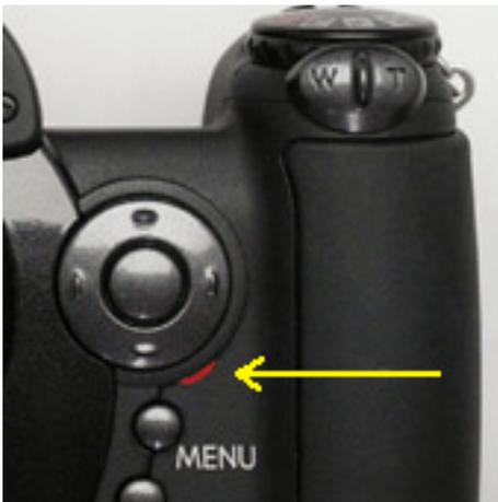
1. Con la cámara apagada, inserte la tarjeta de memoria SD preparada.
